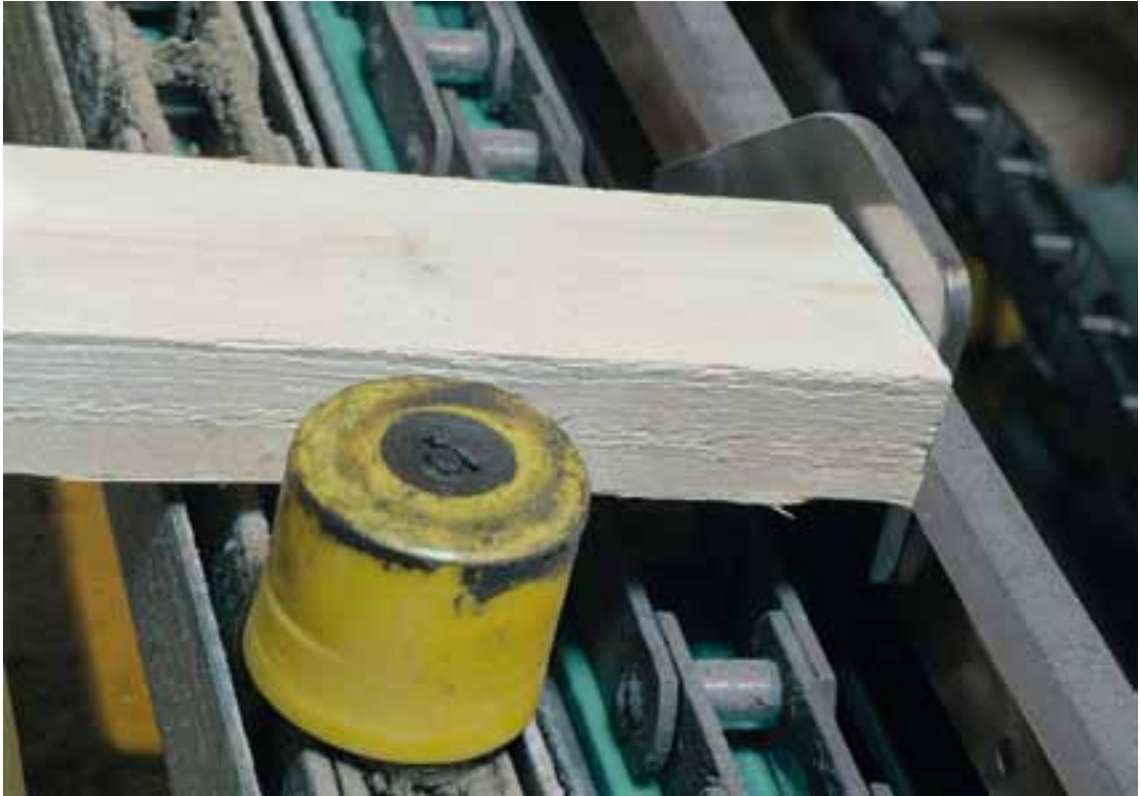
På retursidan kan man låta kedjan vila på medbringarna, men detta gör att medbringarna slits.
